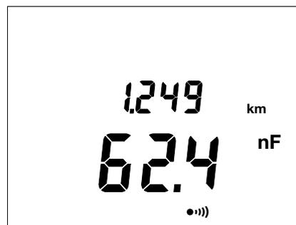
Lo strumento visualizza il valore della capacità nonché la lunghezza della linea corrispondente calcolata mediante la capacità lineica programmata.
