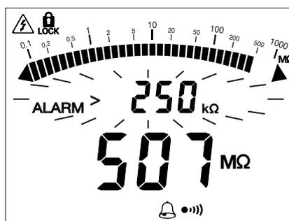
Nel precedente esempio, l'utente può anche controllare che la sua misura di continuità sia ben inferiore a 2 Ω, solo ascoltando e senza guardare il display. L'utente può controllare in maniera identica la qualità dell'isolamento.
