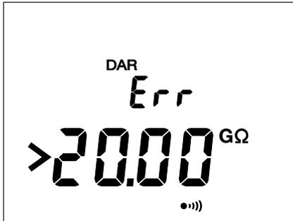
Per il C.A 6532, se ciò si produce durante una misura di DAR o di PI, lo strumento interrompe la misura e visualizza il presente schermo.
