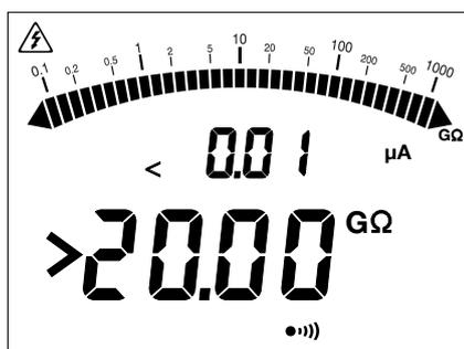
Durante la misura d'isolamento, se il valore da misurare supera la gamma di misura (che dipende dallo strumento e dalla tensione di prova), lo strumento lo segnala.
