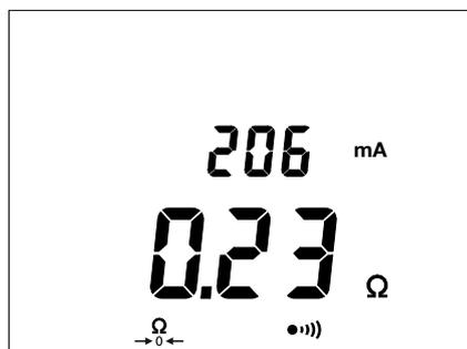
Lo strumento effettua direttamente la misura, visualizza il risultato nonché la corrente di misura.
