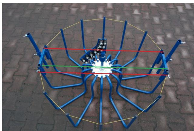
10) **Verificare la regolarità del montaggio in base alla foto; in caso di necessità, regolare di conseguenza**
